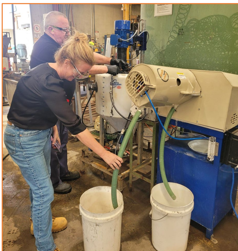
Figure 7 Metallurgical Testwork using a Multi Gravity Separator (MSG)
